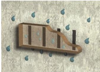
Avec ce type d'application verticale, l'humidité ne peut pas s'accumuler, elle est évacuée sous la pièce collée (humidité de condensation ou eau).
