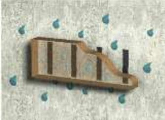
Strangweiser Auftrag (senkrecht): Mit diesem Auftrag kann die zirkulierende Luftfeuchtigkeit die Stränge gut aushärten und nach Erreichen der Endfestigkeit kann Regen, Schnee, Feuchtigkeit perfekt abgeleitet werden.
