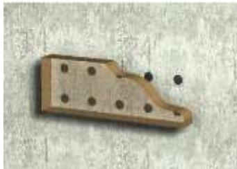
Punktförmiger Auftrag: Leichte, flache Werkstücke können mit Klebepunkten montiert werden. Auch bei dieser Montage ist eine optimale Aushärtung gewährleistet und mögliche Feuchtigkeit wird gut abgeleitet.
