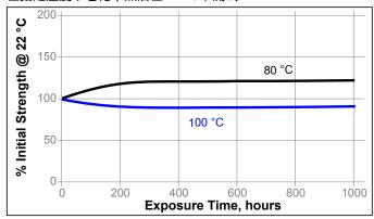
耐化学品/溶剂性能 在指定条件下老化,然后在 23 ℃下测试。
