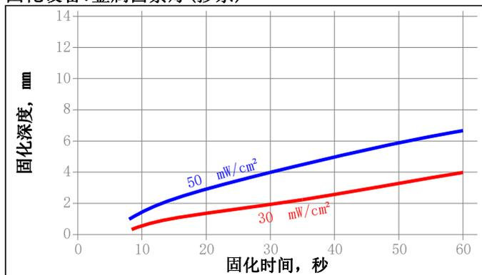
**固化设备：无电极D型灯**
