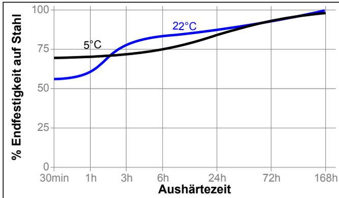
**Aushärtegeschwindigkeit in Abhängigkeit vom Aktivator**
