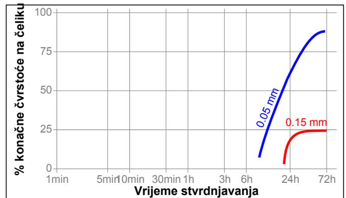
**Brzina stvrđnjavanja ovisno o temperaturi** Brzina stvrđnjavanja ovisi o temperaturi. Grafički prikaz ispod pokazuje razvijanje čvrstoće u odnosu na vrijeme pri različitim temperaturama kod M10 čelične matice i vijka testirano prema ISO 10964.
