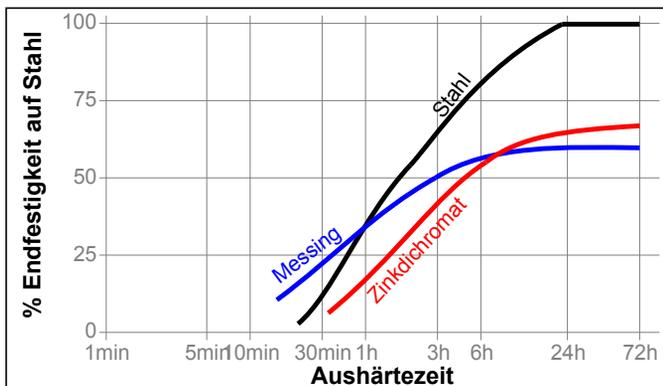
Die Aushärtegeschwindigkeit ist abhängig von der Temperatur. Das untenstehende Diagramm zeigt die zeitliche Entwicklung der Losbrechfestigkeit bei vergütungsschwarzen Schrauben und Muttern M10 bei unterschiedlichen Temperaturen. Geprüft gemäß ISO 10964.
