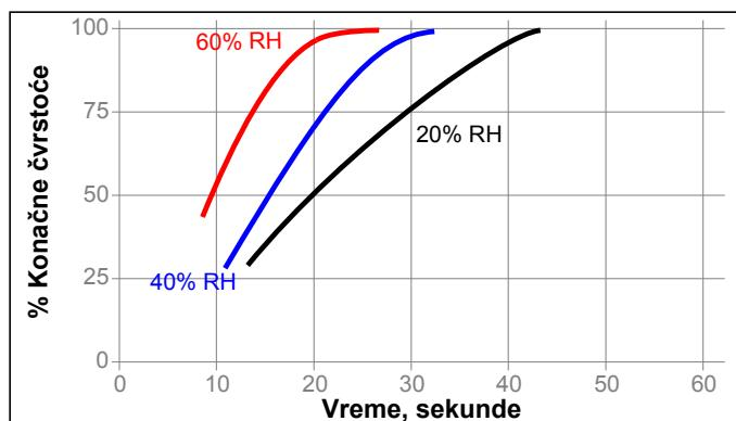
**Brzina očvršćavanja u zavisnosti od aktivatora**
