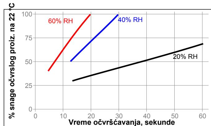
**Brzina očvršćavanja u zavisnosti od aktivatora**
