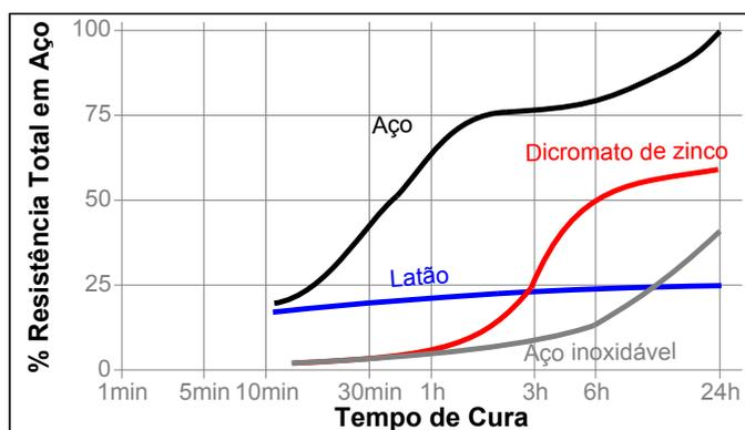
LOCTITE® 271™ é indicado para o travamento e vedação permanente de superfícies roscadas. O produto cura quando confinado entre superfícies metálicas e na ausência de ar, e evita o afrouxamento e vazamento originados por impacto e vibração. Aplicações típicas incluem o travamento e vedação de grandes parafusos e porcas (até M25).
