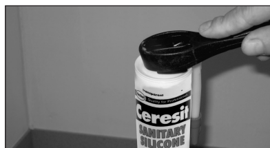
Cu ajutorul lamei incluse se desiglează cartușul la partea superioară, deasupra filetului
