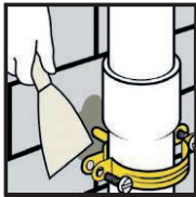
Поставување на држач кај водоводна цевка
