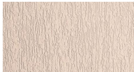
Ceresit CT 35 минералдық сылағы, түйірі 2,5 мм, жағу құралы: болат үккіш, фактуралау құралы: пластмасса үккіш.
